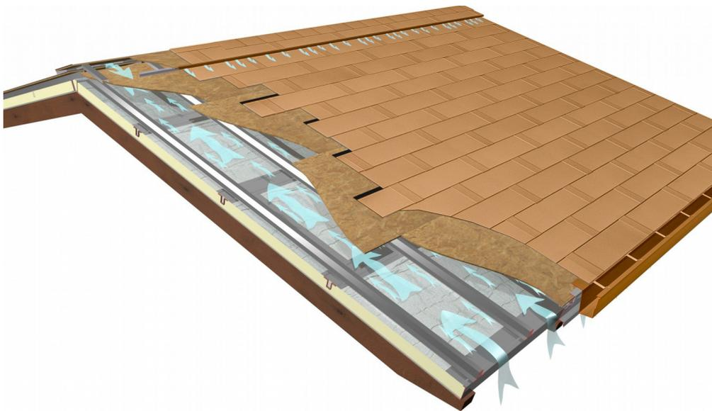
*Particolare costruttivo copertura ventilata e posa in opera delle lastre di rame*
